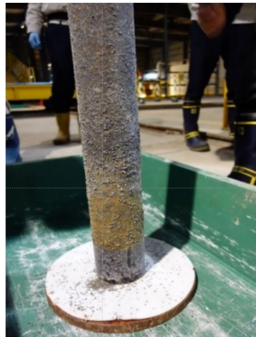
試験の模式図 (左) と試験後の模擬オーバーパックの写真 (右)
